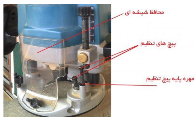
شکل ۸- دو تصویر از پیچ های تنظیم عمق و ارتفاع در اور فرز
