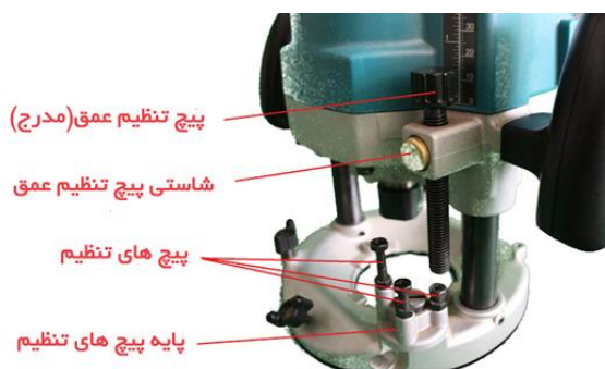
شکل ۸- دو تصویر از پیچ های تنظیم عمق و ارتفاع در اور فرز
