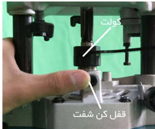
شکل ۷- تنظیم تیغه کولت در اور فرز
